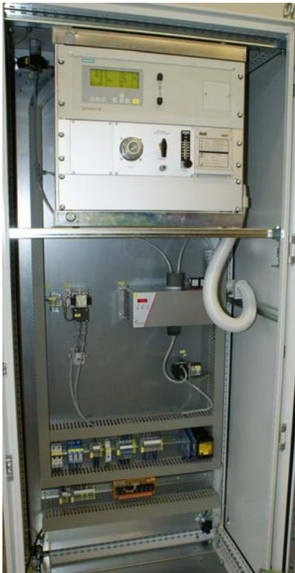
Das **Gasanalyzesystem NGA2** ist ein für den stationären Dauerbetrieb konzipiertes System zur Analyse von Deponie-, Klär-, Gruben- oder Biogas.
